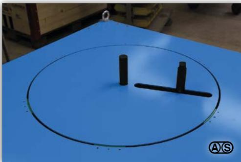
Wickelachse in der Höhe sowie Achsabstand verstellbar
