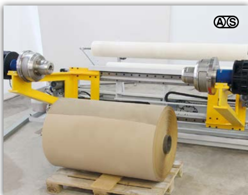
Stufenspannköpfe für mehrere Kerndurchmesser (Option)
