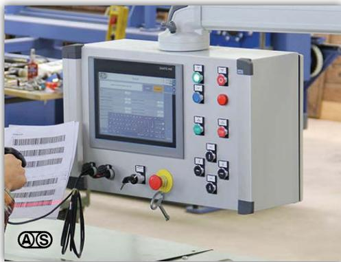
Barcode-Lesegerät (optional) zur vollautomatischen Einstellung der Aggregate für den nächsten Auftrag
