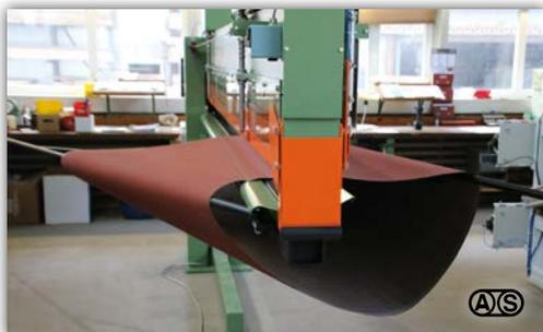
Ausklappbare, seitlich angebrachte Bandstützen
