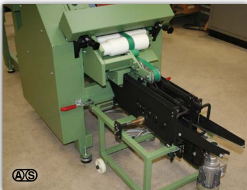
Stapler Typ SA mit automatischem Ausstosser
