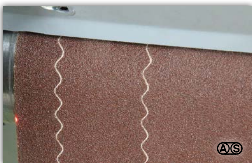
Messersteuerung anhand detektiertes Bandkante
