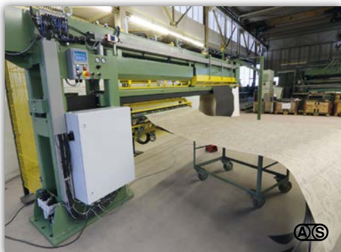
Einlegen/fügen eines neuen Bandes während laufendem Presszyklus
