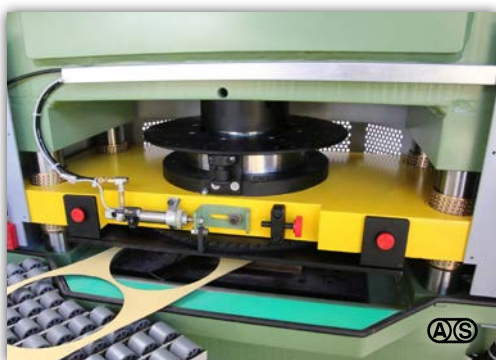
Automatische Rotation der Stanzunterlage um Verschleiss zu reduzieren
