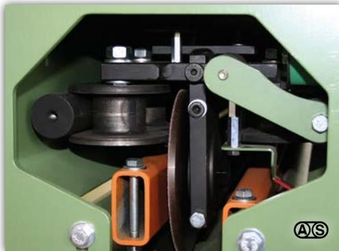
Einblick in die Scherschnitt Schneidmaschine Typ STB
